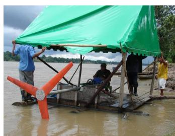
Figure 1: A river current turbine in Peru. Photo: Soluciones Prácticas.
