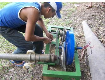
Figure 4: Setting up the fan belt and permanent magnet generator . Photo: Soluciones Prácticas.
